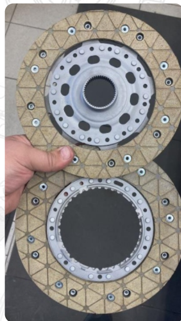
Фрикционные накладки из кевлара
