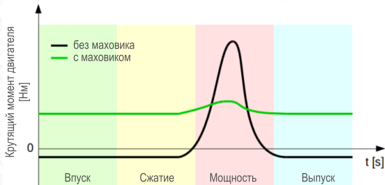
Крутящий момент двигателя во время 4-тактного цикла.
