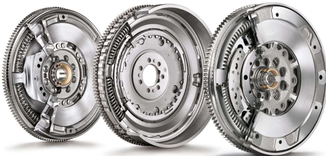
DMF с центробежным амортизатором маятникового типа
